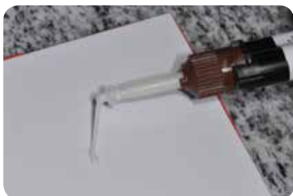
Abb. 10: Überprüfung der gleichmässigen Durchmischung auf dem Mischblock
