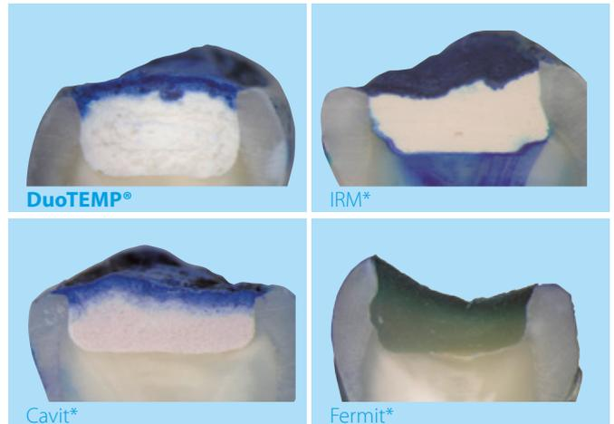
Querschnitt von einem mit ausgehärtetem DuoTEMP gefüllten extrahierten Molar, welcher in Methylenblau eingelegt wurde, um die Penetration zu testen. DuoTEMP zeigt eine hervorragende Randdichte. Quelle: Interne Daten
