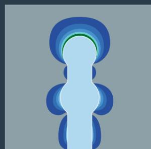
La cabeza redondeada de Fiber Lux y Fiber White reduce el estrés en el material de restauración, previniendo así las microfracturas.
