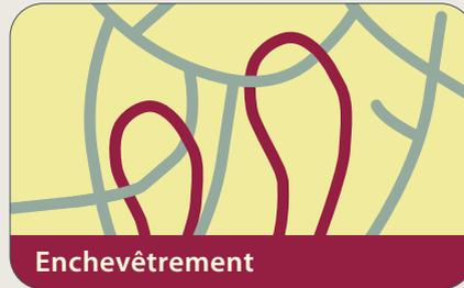
Des chaînes de polymères se forment pendant la polymérisation des monomères, ces derniers étant ancrés dans la résine matrice.
