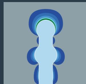
La tête arrondie de Fiber Lux et Fiber White réduit les contraintes sur le matériau du noyau, prévenant ainsi les microfractures
