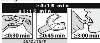
Un malaxage excessif ainsi que des températures et une humidité élevées accélèrent la polymérisation des matériaux pour empreinte. Les basses températures ralentissent le processus de polymérisation.
