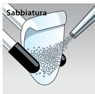
Sabbare la superficie adesiva da unire con ossido di alluminio di granulometria 25-50  $\mu\text{m}$  a 1,5 bar.
