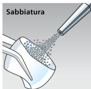
Sabbiare la superficie adesiva da unire con ossido di alluminio di granulometria 25-50  $\mu\text{m}$  a 1,5 bar.
