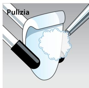
Pulire in un bagno a ultrasuoni (ad es. 1 minuto, etanolo 70%) o con vaporizzatrice (ad es. 5 secondi per unità, 4,5 bar).
