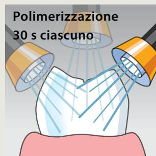
Fotopolimerizzare ciascuna superficie del restauro per 30 secondi (intensità luminosa  $\geq 800 \text{ mW/cm}^2$ ).
