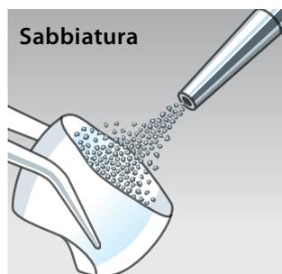
Sabbiare la superficie adesiva da unire con ossido di alluminio di granulometria 25-50  $\mu\text{m}$  a 1,5 bar.
