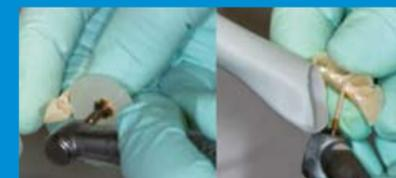
Per rimuovere il materiale in eccesso e per trattare la superficie è possibile utilizzare strumenti rotanti, lucidatori, ecc. Lo strato inibitore che si forma sulla superficie al contatto con l'ossigeno dell'aria può essere eliminato con alcool.
