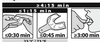
Amassar bastante; temperaturas e humidade elevadas aceleram a presa dos materiais de impressão. As temperaturas baixas retardam o processo de presa. O tempo de polimerização pode ser aumentado ou reduzido mediante sobredosagem e subdosagem do Speedex Universal Activator (máx. ± 20% da dosagem normal).
