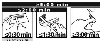
Интенсивное смешивание, высокие температуры и повышенная дозировка катализатора ускоряют полимеризацию; низкие температуры и пониженная дозировка катализатора замедляют полимеризацию. Всегда работайте в защитных перчатках.
